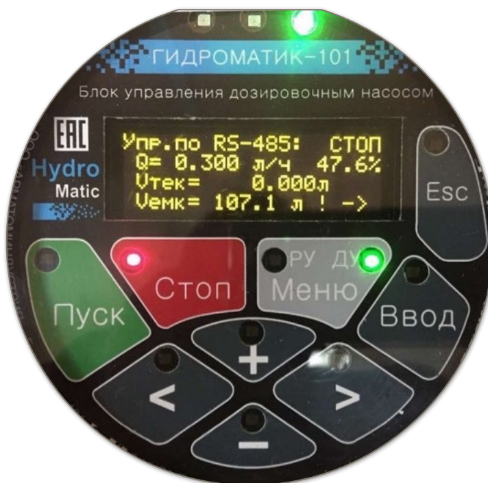
Рисунок 10: Главный экран 88 в режиме ДУ, дозирование остановлено, стрелочка в нижнем правом углу говорит о готовности к вводу нового значения уровня реагента в баке
