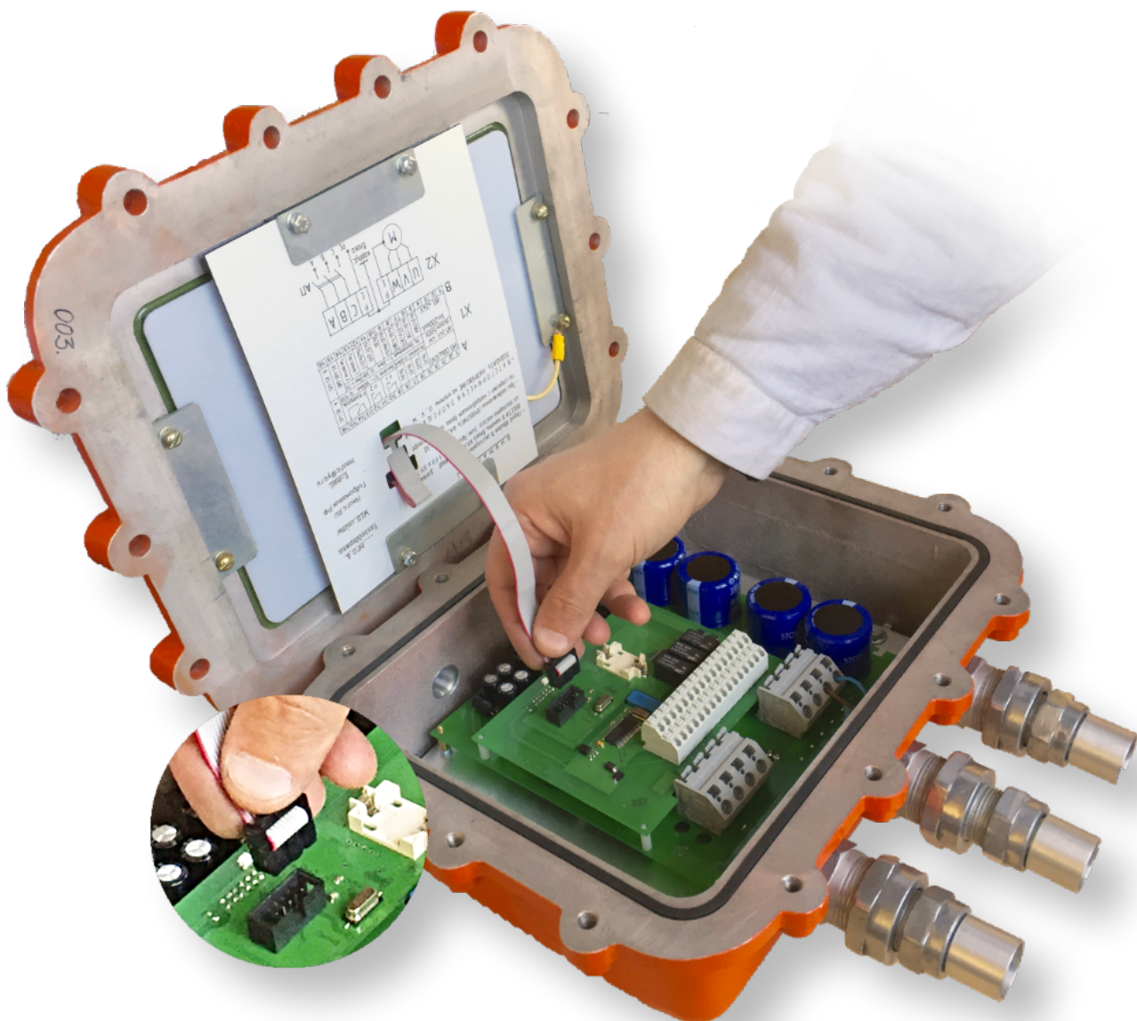
Рис. 7 Внутреннее устройство взрывобезопасного исполнения Гидроматик-102 типоразмер корпуса 2
