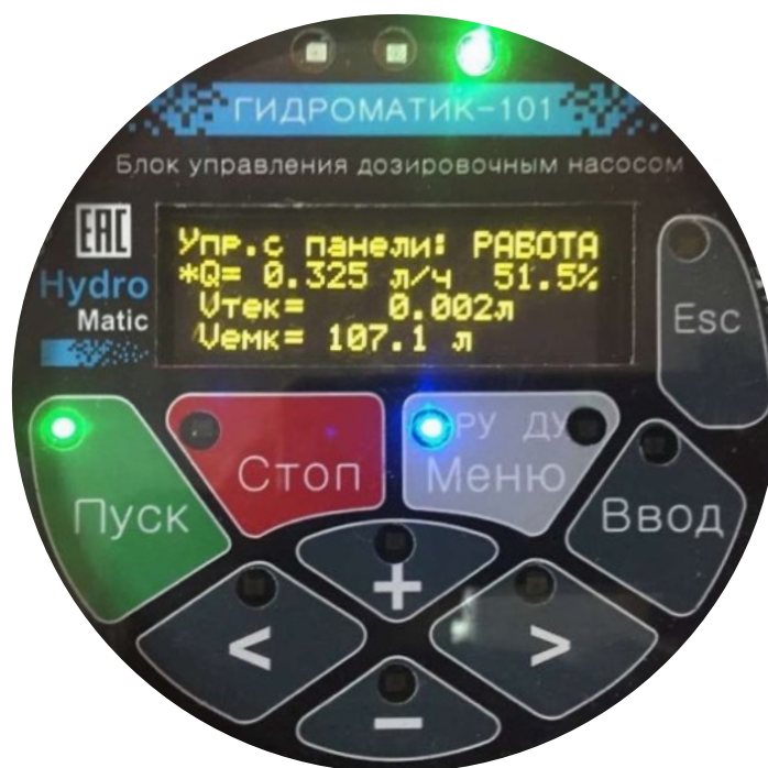
Рисунок 11: Главный экран 87 в режиме РУ в процессе дозирования, с введенным, но не подтвержденным 88 новым заданием подачи.
