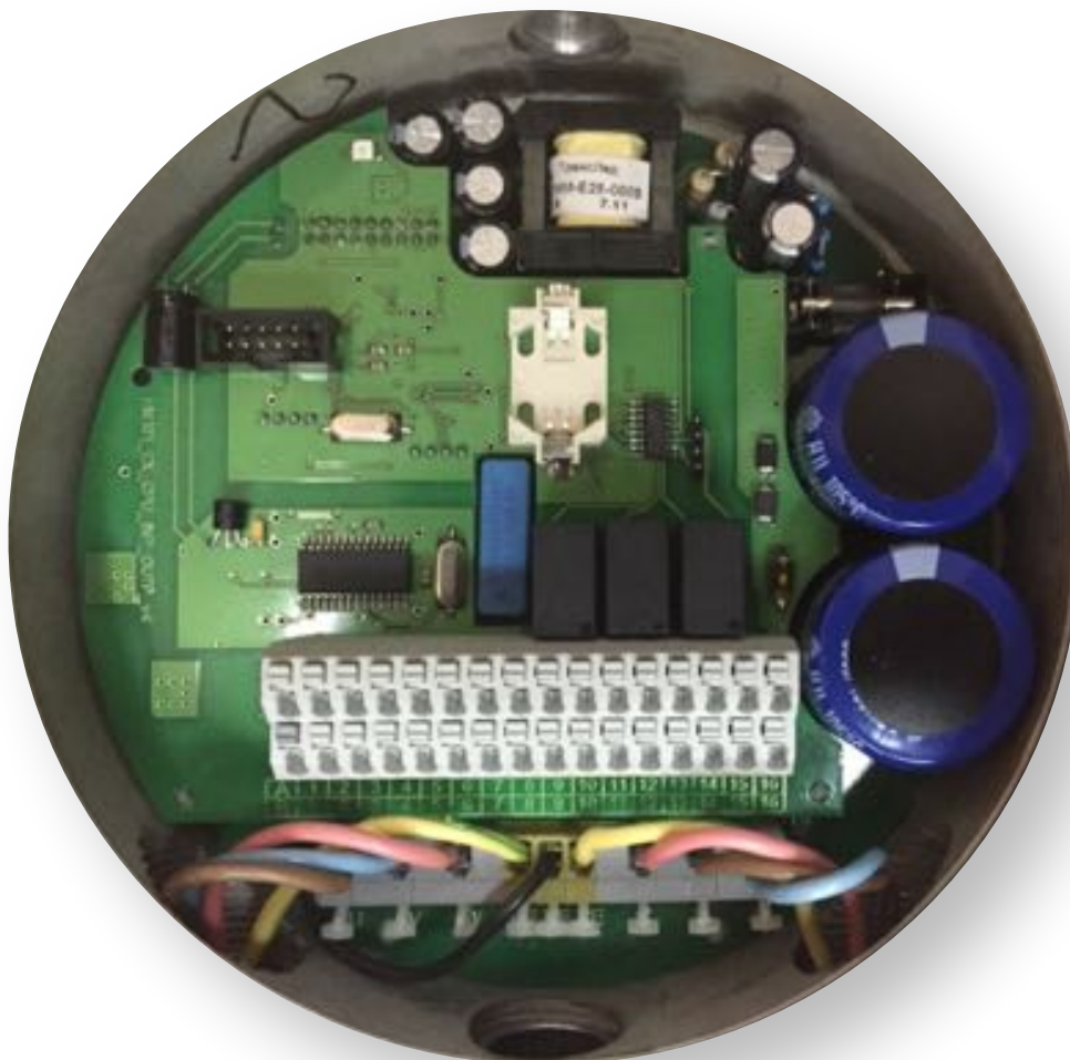
Рис. 6 Внутреннее устройство взрывобезопасного исполнения Гидроматик-102 типоразмер корпуса 1
