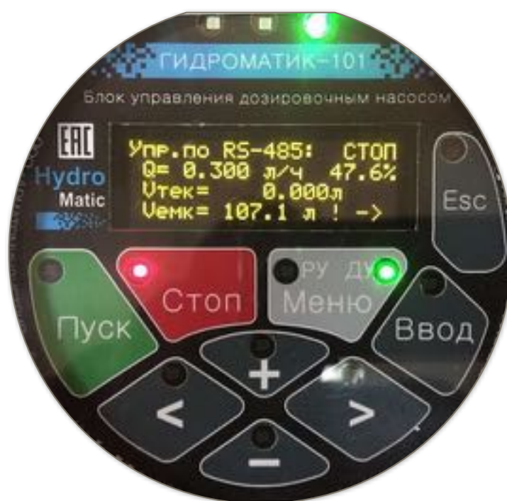
Рисунок 10: Главный экран 94 в режиме ДУ, дозирование остановлено, стрелочка в нижнем правом углу говорит о готовности к вводу нового значения уровня реагента в баке
