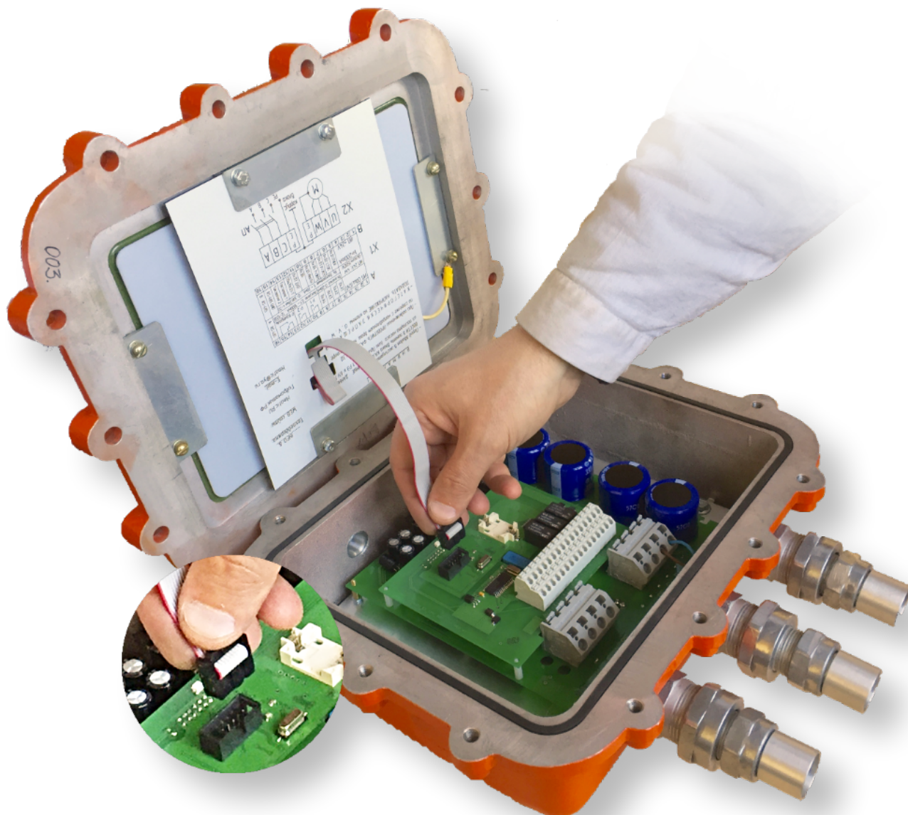
Рис. 7 Внутреннее устройство взрывобезопасного исполнения Гидроматик-102 типоразмер корпуса 2 (исполнение УХЛЗ)
