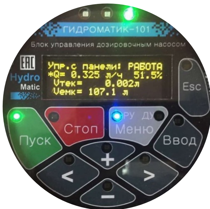
Рисунок 11: Главный экран 107 в режиме РУ в процессе дозирования, с введенным, но не подтвержденным 108 новым заданием подачи.
