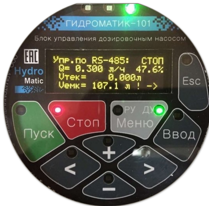
Рисунок 10: Главный экран 104 в режиме ДУ, дозирование остановлено, стрелочка в нижнем правом углу говорит о готовности к вводу нового значения уровня реагента в баке
