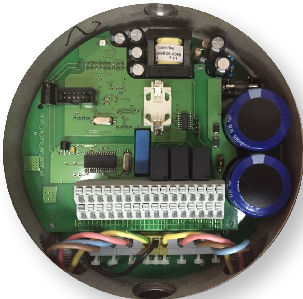
Рис. 6 Внутреннее устройство взрывобезопасного исполнения Гидроматик-102 типоразмер корпуса 1 (исполнение УХЛЗ)
