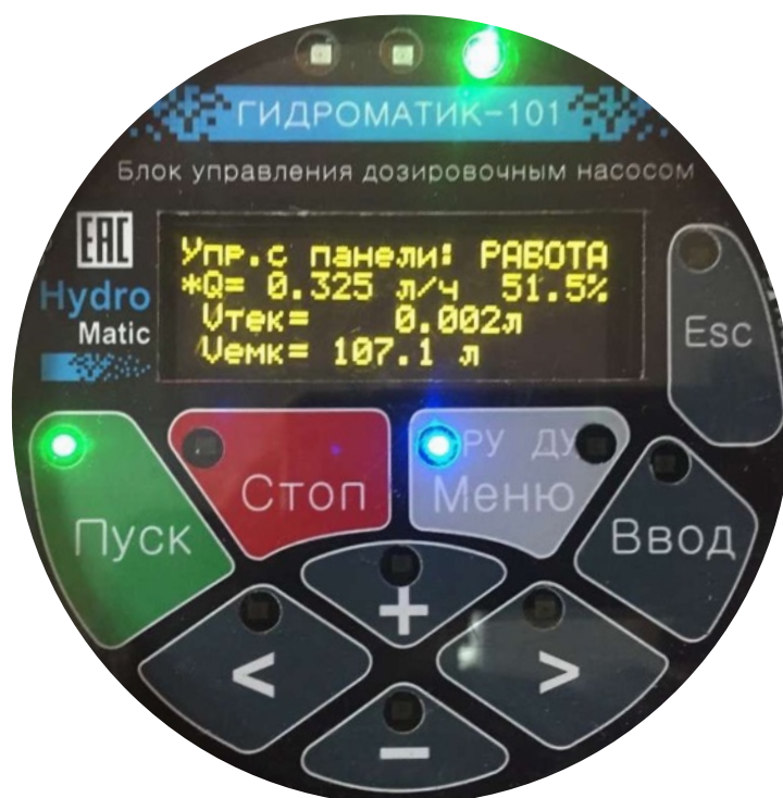
Рисунок 5 – Главный экран в режиме РУ в процессе дозирования, с введенным, но не подтвержденным новым заданием подачи.
