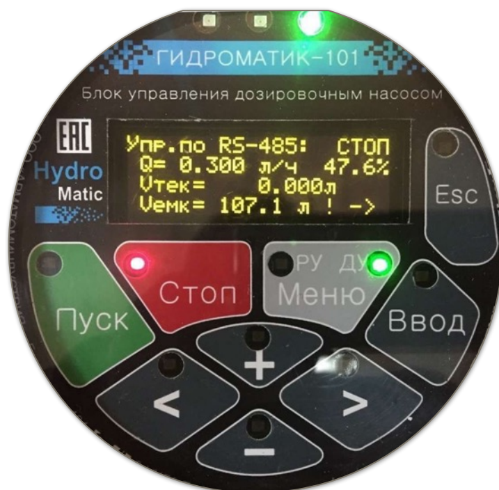
Рисунок 4 – Главный экран в режиме ДУ, дозирование остановлено, стрелочка в нижнем правом углу говорит о готовности к вводу нового значения уровня реагента в баке
