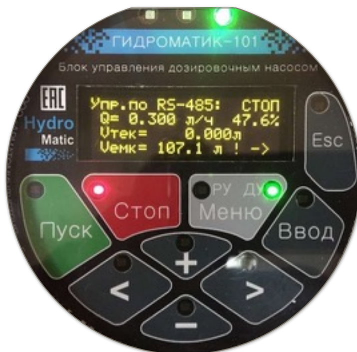
Рисунок 6 – Главный экран 39 в режиме ДУ, дозирование остановлено, стрелочка в нижнем правом углу говорит о готовности к вводу нового значения уровня реагента в баке
