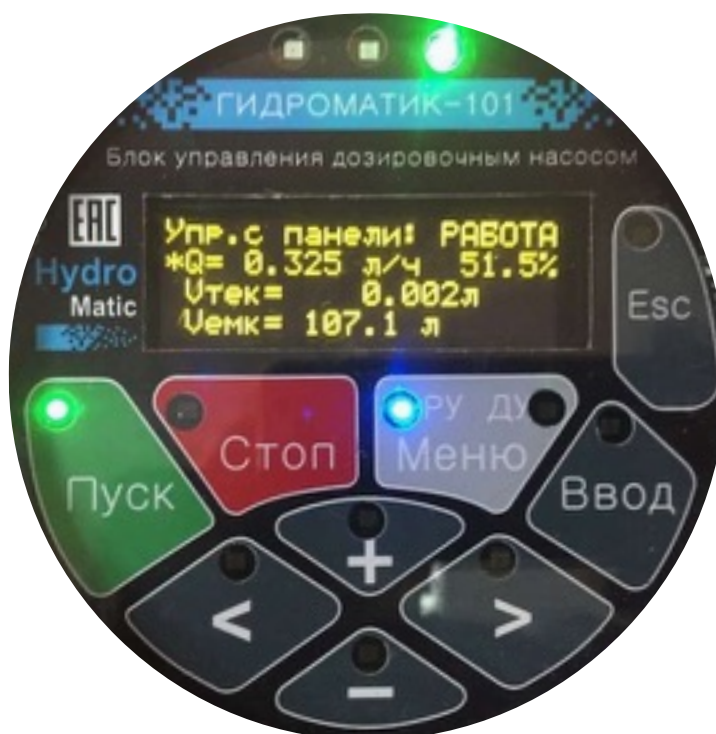
Рисунок 7 – Главный экран 47 в режиме РУ в процессе дозирования, с введенным, но не подтвержденным новым заданием подачи.
