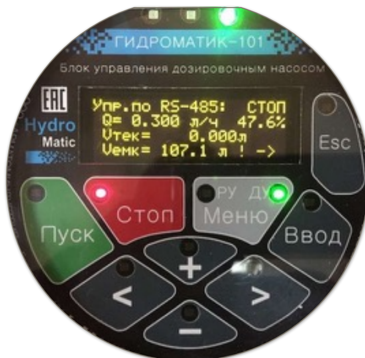
Рисунок 10: Главный экран 45 в режиме ДУ, дозирование остановлено, стрелочка в нижнем правом углу говорит о готовности к вводу нового значения уровня реагента в баке
