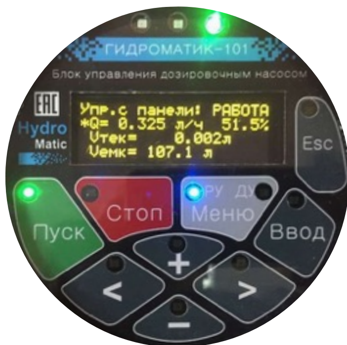
Рисунок 11: Главный экран 48 в режиме РУ в процессе дозирования, с введенным, но не подтвержденным 49 новым заданием подачи.
