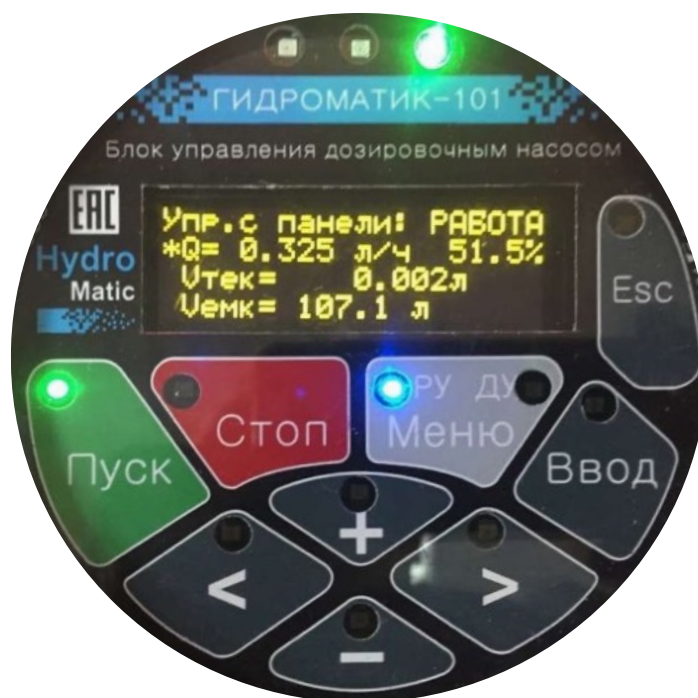
Рисунок 11: Главный экран 78 в режиме РУ в процессе дозирования, с введенным, но не подтвержденным 79 новым заданием подачи.
