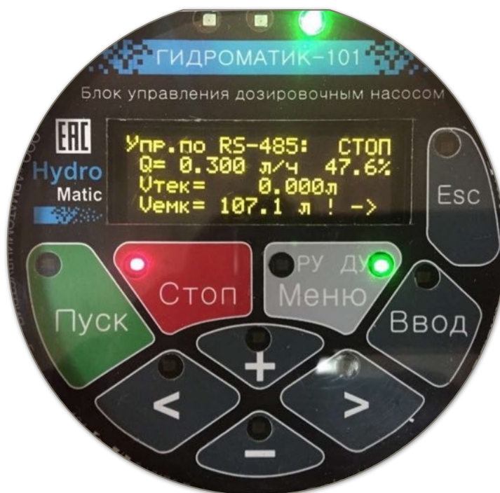
Рисунок 10: Главный экран 75 в режиме ДУ, дозирование остановлено, стрелочка в нижнем правом углу говорит о готовности к вводу нового значения уровня реагента в баке
