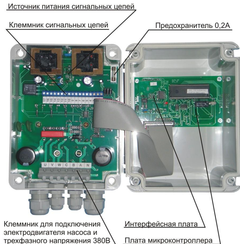
Рисунок 4 – Устройство блока управления БУДН-032ЧР-0,4, БУДН-032ЧР-0,75, БУДН-032ЧР-1,5, БУДН-032ЧР-2,2 и БУДН-032ЧР-3,7
